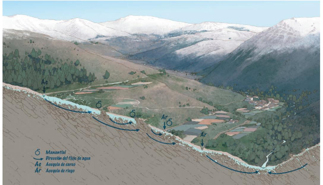
Esquema hidrogeológico de funcionamiento de los acuíferos en pendiente recargados con acequias de careo durante el periodo de deshielo
